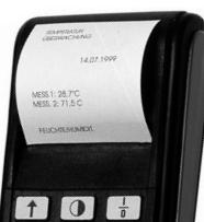
Ручная распечатка запускает автоматическую распечатку через 10 мин.
